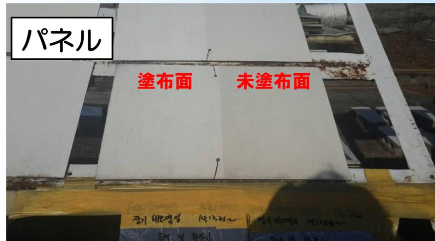
パネル面もドラム缶も明らかに塗布面がキレイに見える。帯電防止と超親水効果によるものと推察される。一方ドラム缶未塗布の雨だれはさらにひどくなり、塗布面がキレイなままであることから、超親水膜が雨だれ抑止に効果があることが分かる。
