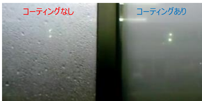
HOTガード未塗布・塗布の結露(2時間)
