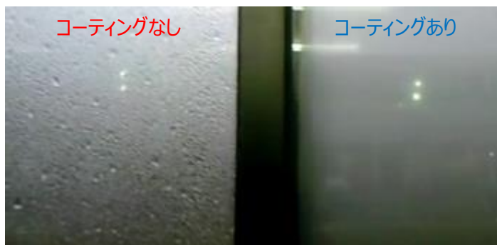
節電ガラスコートPRO塗布・未塗布の結露状態の違い
