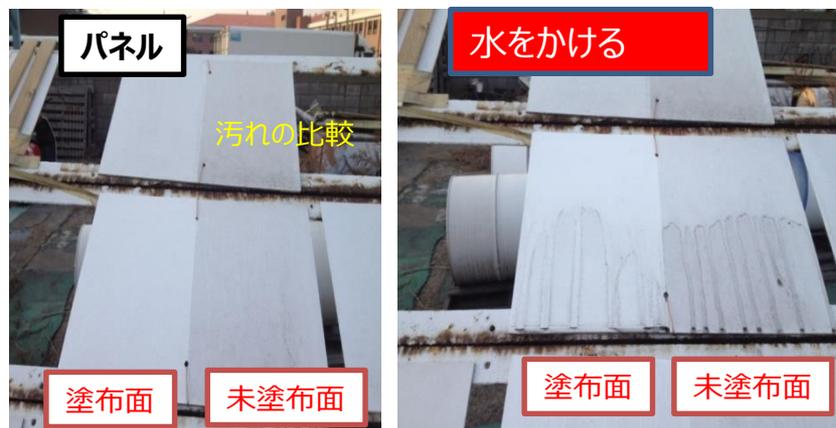
中国、韓国など汚れがひどい国の場合、赤外線反射率が汚れにより5%以上落ちてしまいます。コート面は汚れが固着しないため、水をかけるときれいになります。
