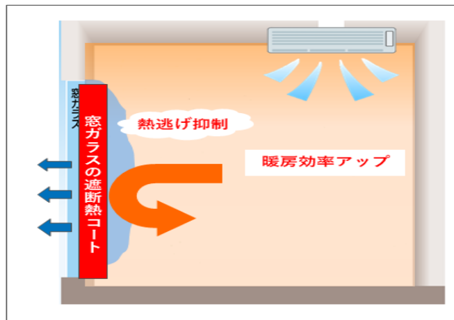
<窓ガラスの遮断熱コートを塗布>
